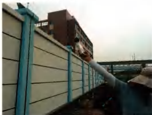
站址南侧围墙外声环境现状检测
