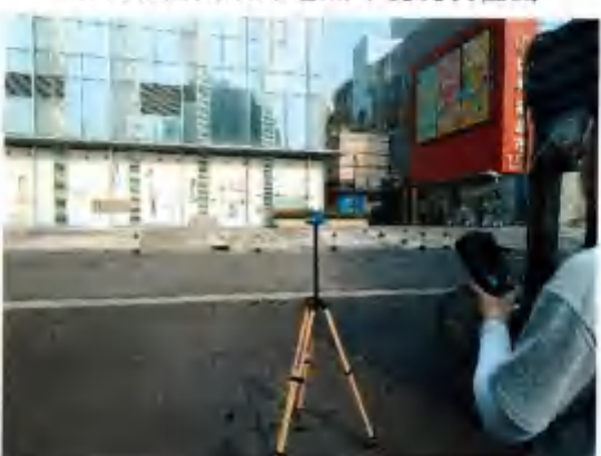
电缆线路电磁环境断面检测
